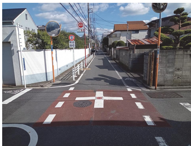
外側線や交差点部での路面表示
