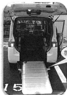
後部スロープ付車いす直接乗車タイプ
